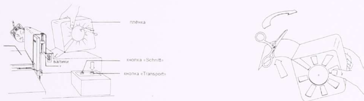
Рисунок 3 – Установка картриджа с фильмом
